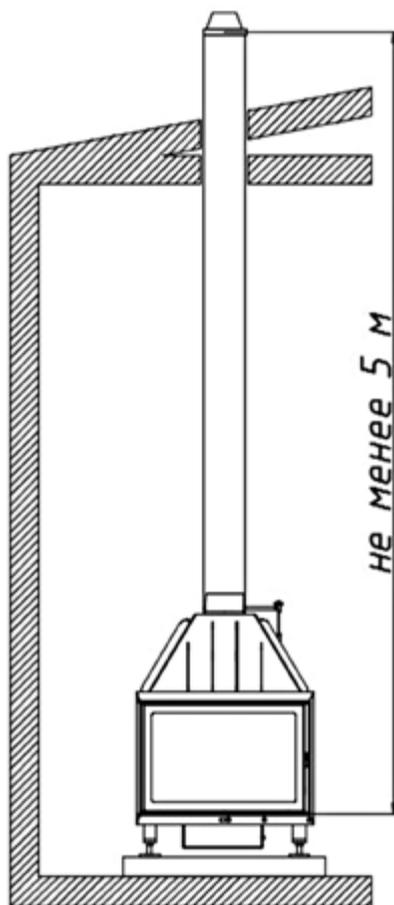
**ВНИМАНИЕ!** Неправильное проектирование и кладка (монтаж) дымовых труб (каналов) может отрицательно влиять на процесс горения и вызвать попадание продуктов горения в помещение.
