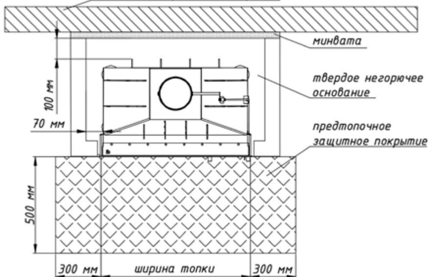
У стен или перегородок, не защищенных от возгорания, необходимо возвести защитную стенку из негорючего материала (кирпича, силиката кальция т.п.) с применением дополнительного теплоизоляционного покрытия из базальтовой ваты толщиной минимум 30 мм между защитной стенкой и незащищенной стеной. Защитная стенка должна быть минимум на 300 мм выше дымоотводящего патрубка топки. В местах примыкания топки к стенам и перегородкам недопустима прокладка электрических проводов.
