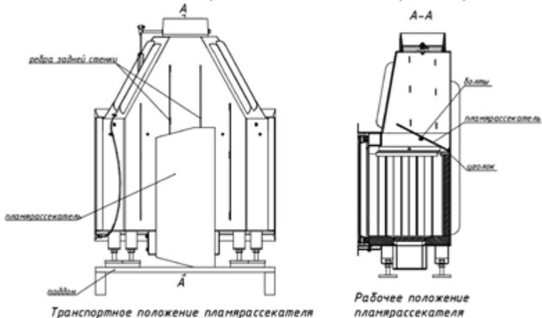
В транспортном положении пламярассекатель прикреплен снаружи топки к ребрам задней стенки и опирается на поддон.
