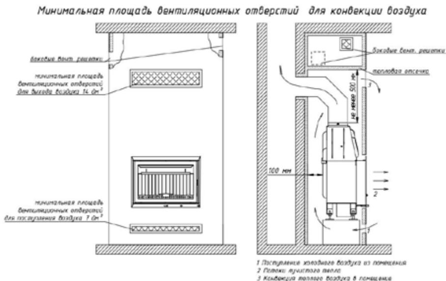
При проектировании и кладке (монтаже) дымовых труб (каналов) для каминов на твердом топливе необходимо предусматривать решения и нормы, изложенные в своде правил СП 60.13330.2012 «Отопление, вентиляция и кондиционирование».
