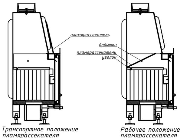
В транспортном положении пламярассекатель закреплен над дверцей.
