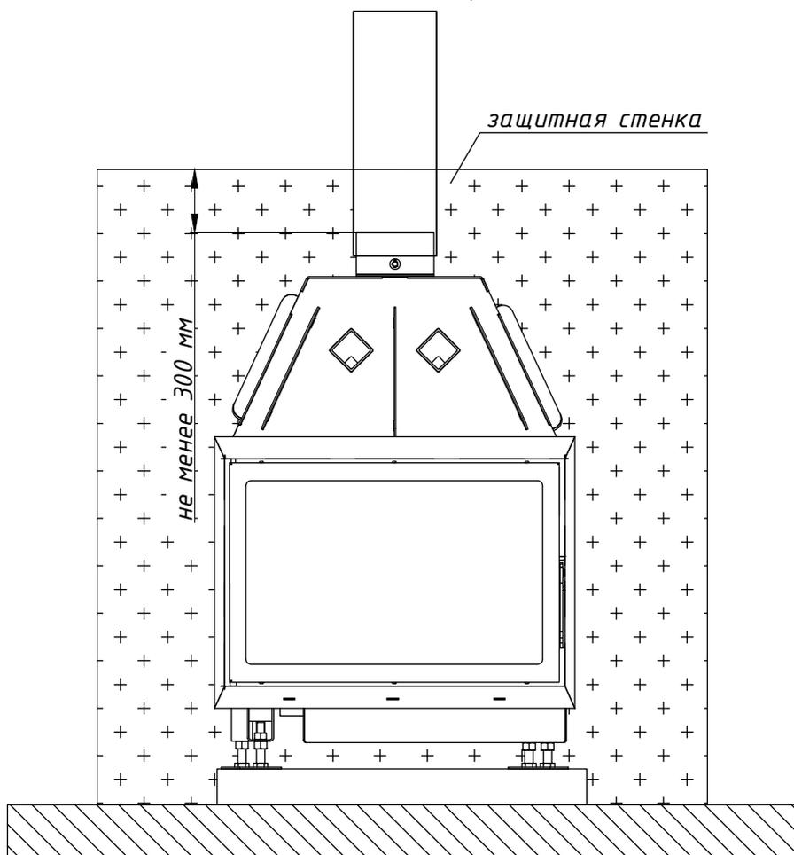
Используя регулировочные ножки, установите топку по уровню в горизонтальной и вертикальной плоскости.
