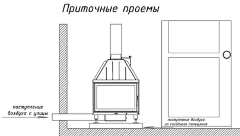
**ВНИМАНИЕ!** Неправильный технический расчет площади приточных проемов для поступления воздуха в помещение, где установлен камин, а также принудительная вентиляция, кондиционер, вытяжка на кухне и т.п. могут отрицательно влиять на процесс горения и вызвать попадание продуктов горения в помещение.
