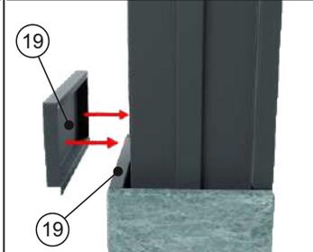
9 Установите уголки «3У» - 2 шт по углам в передней части и уголки «2У» - 2 шт в задней части, закрепите болтами М5х20 - 4 шт к деталям из камня и М6х10 - 4 шт к металлическим панелям.
