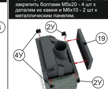
12 Установите уголки «4У» - 2 шт по углам в передней части и уголки «2У» - 2 шт в задней части, закрепите болтами М5х20 - 4 шт к деталям из камня и М6х10 - 2 шт к металлическим панелям.
