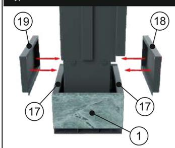
6 Установите уголки «2У» - 4 шт по внутренним углам облицовки и закрепите болтами М6х10 - 4 шт к металлическим панелям и болтами М5х20 - 4 шт к деталям из камня.
