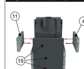
14 Установите деталь «19», установите уголки «4У» - 2 шт по углам в передней части и уголки «2У» - 2 шт в задней части, закрепите болтами М5х20 - 4 шт к деталям из камня и М6х10 - 2 шт к металлическим панелям.
