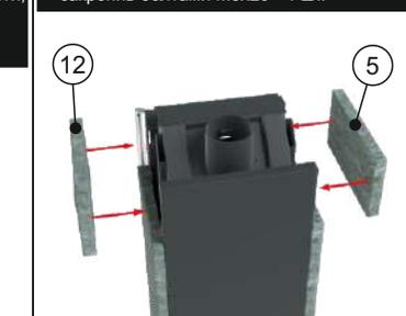
16 Установите деталь «19», выравнивая с деталью «19» нижнего уровня. Установите уголки «2У» - 2 шт по углам в передней части и уголки «2У» - 2 шт в задней части, закрепите болтами М6х10 - 2 шт к металлическим панелям и М5х20 - 4 шт к деталям из камня.
