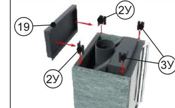
17 Установите деталь «17», закрепив болтами М6х10 - 2 шт. Установите детали «6» и «13» вплотную к уголкам «2У» и «3У», закрепив болтами М5х20 - 4 шт.
