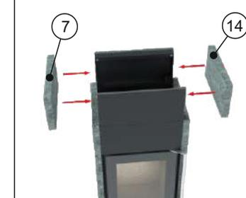
20 Установите верхнюю рамку, совмещая прорези на рамке с крепежными отверстиями на камне и на металлических панелях, закрепите болтами М6х10 - 4 шт и М5х20 - 4 шт.
